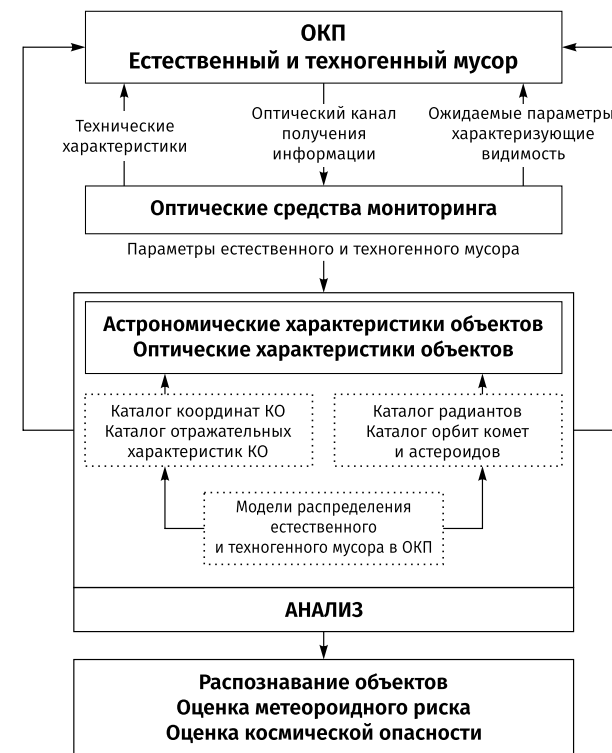
Рис. 1. Схема организации системы мониторинга объектов в ОКП оптическими средствами.
